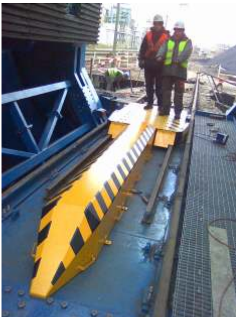
Schéma zachycení dvojkolí vagonu vozíkem HW1E:
